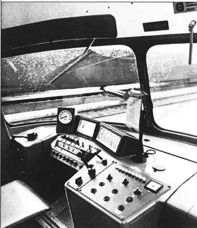
A droite : détails du panneau de commande des pantographes et des asservissements électriques en fonction des systèmes de courant rencontrés.
